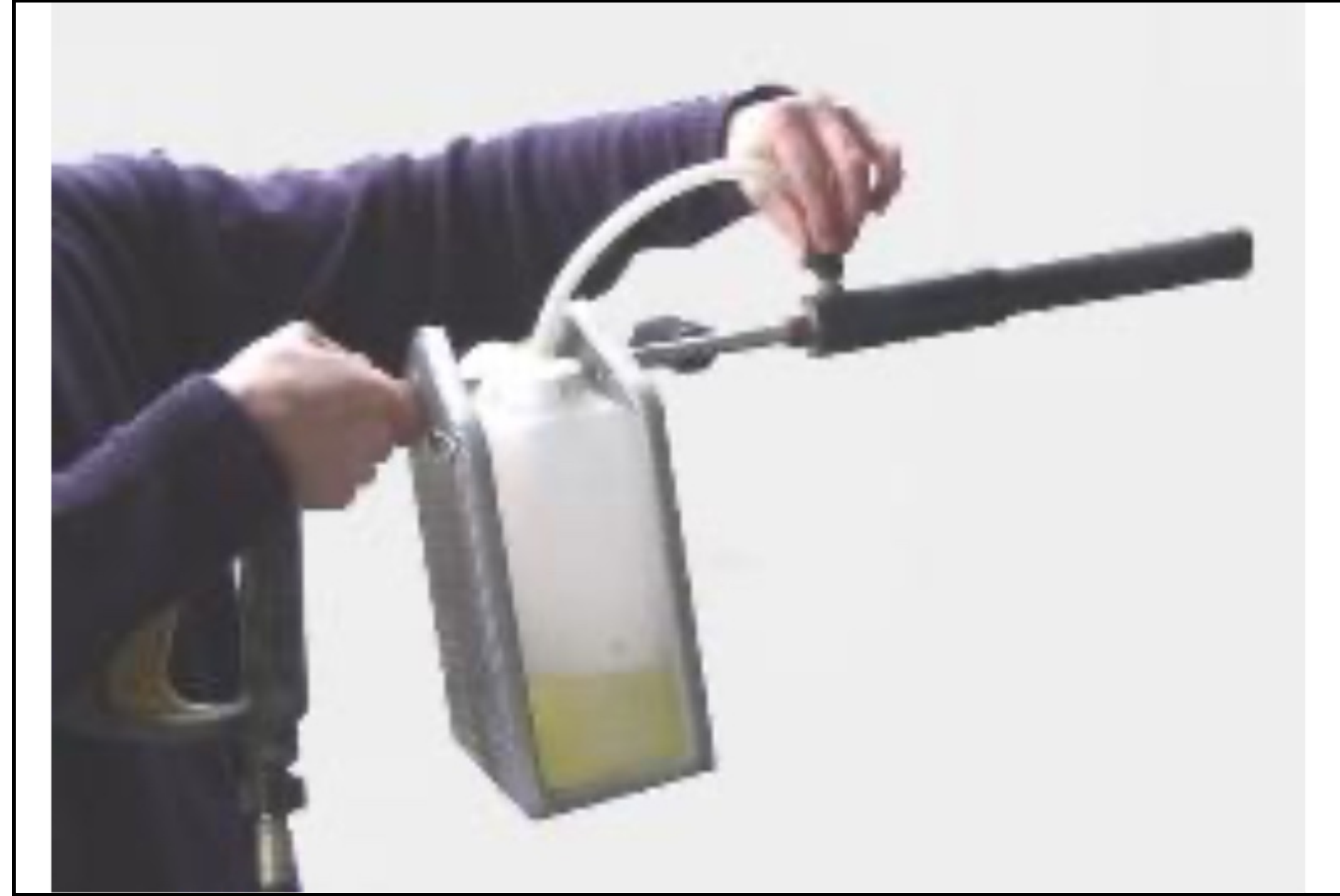
Utilisation au canon ou à la lance à mousse : temps de contact prolongé sur les surfaces
