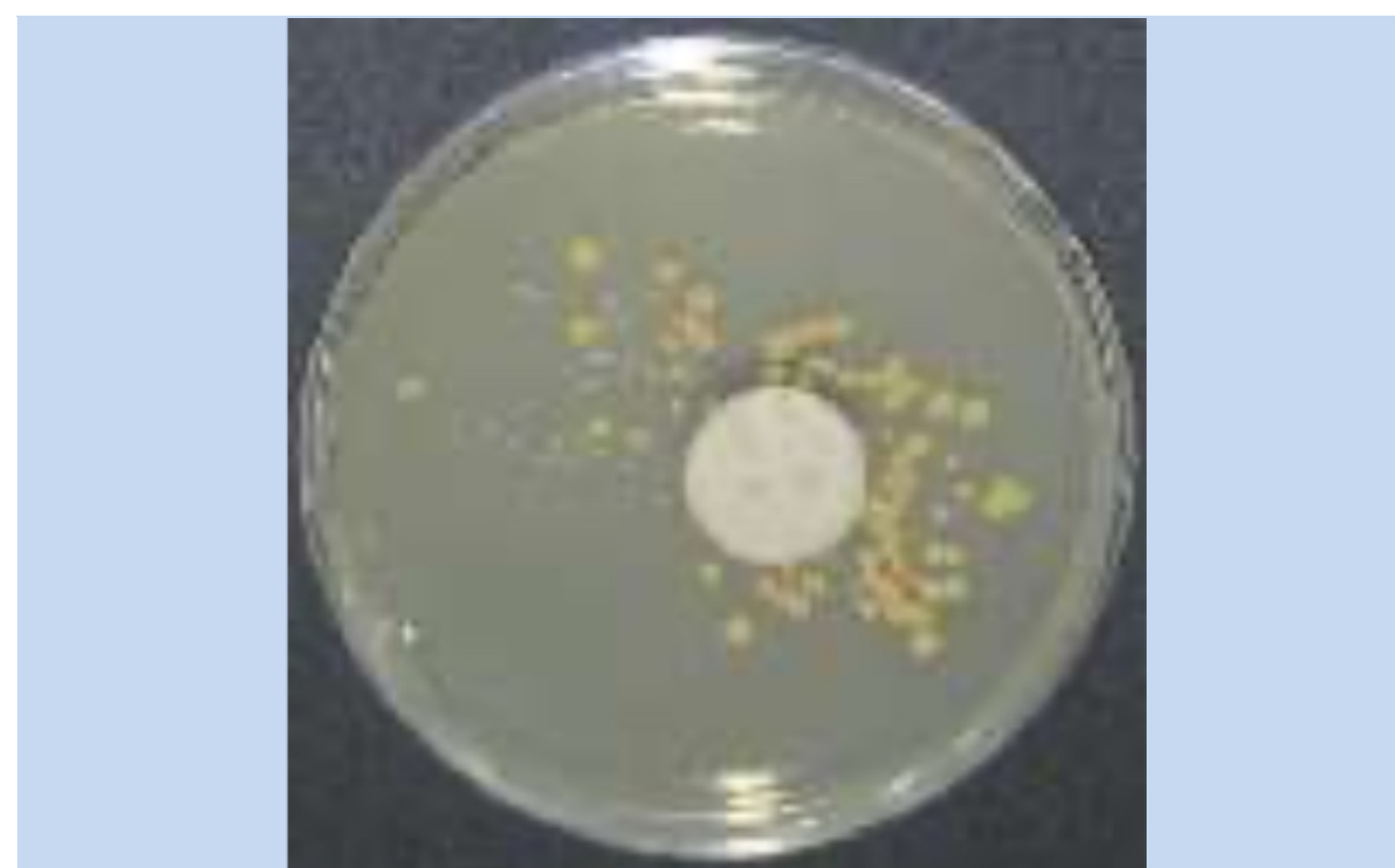
Surface après nettoyage avec un nettoyant sans enzymes : il reste de nombreuses colonies de microorganismes
