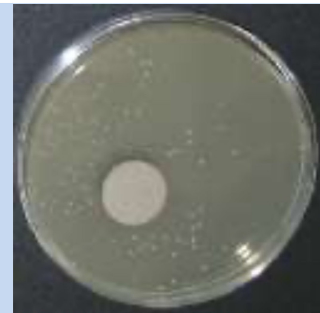
Surface après nettoyage avec le nettoyeur enzymatique : réduction très significative du nombre de colonies de microorganismes
