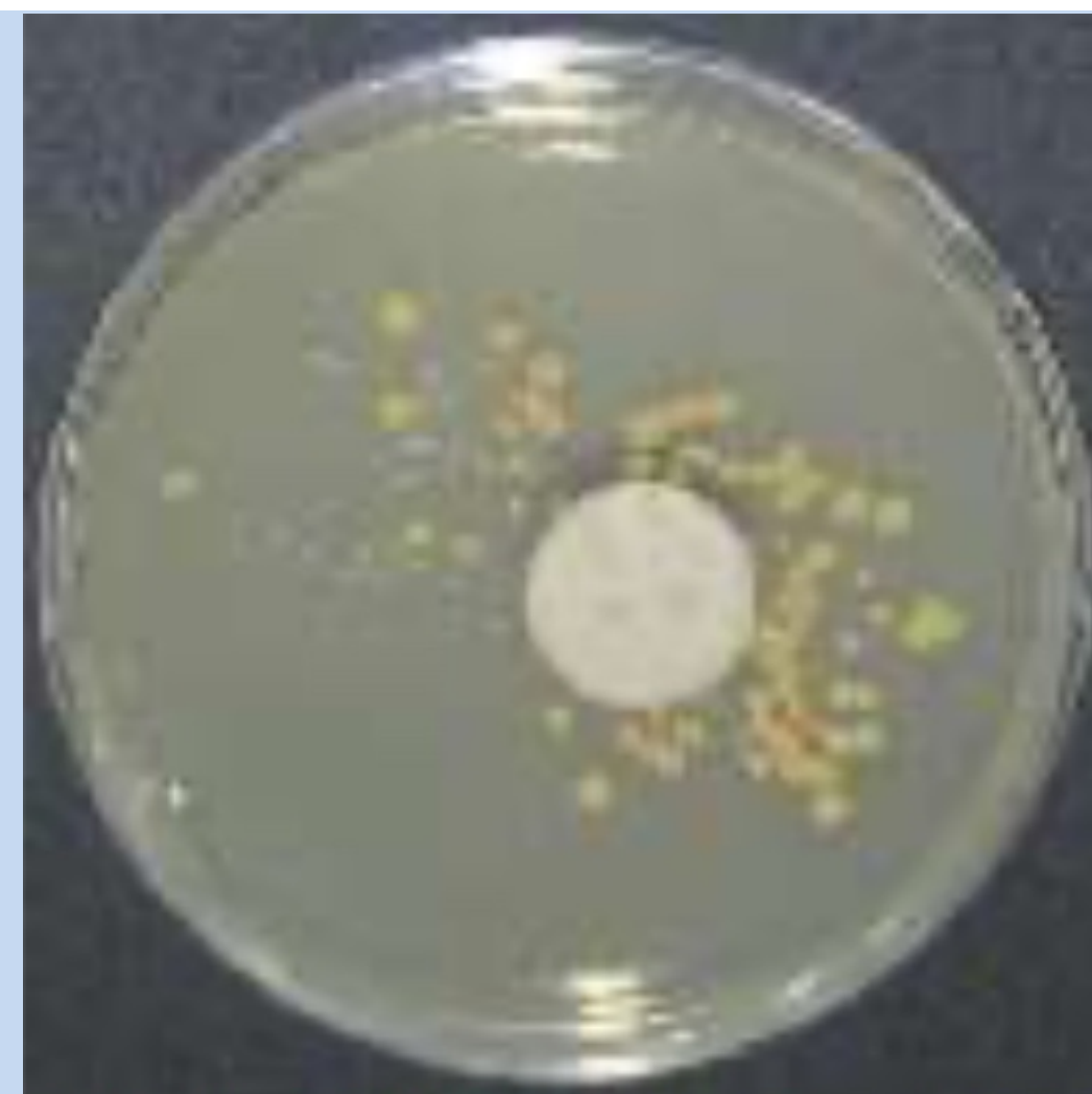
Surface après nettoyage avec un nettoyeur sans enzymes : il reste de nombreuses colonies de microorganismes
